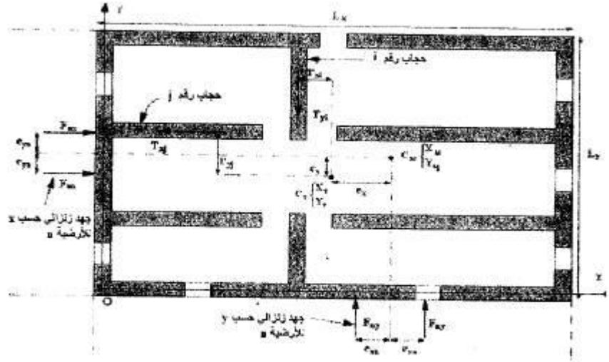
الشكل 20. مقاومة الرياح بجدران وأرضية صلبة
